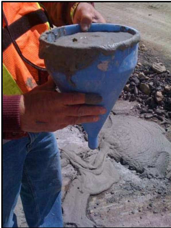
AASHTO Flow cone test
